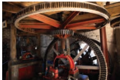
Mécanisme intérieur avec pignon de fonte du moulin de la Pannevert, Rouen.
