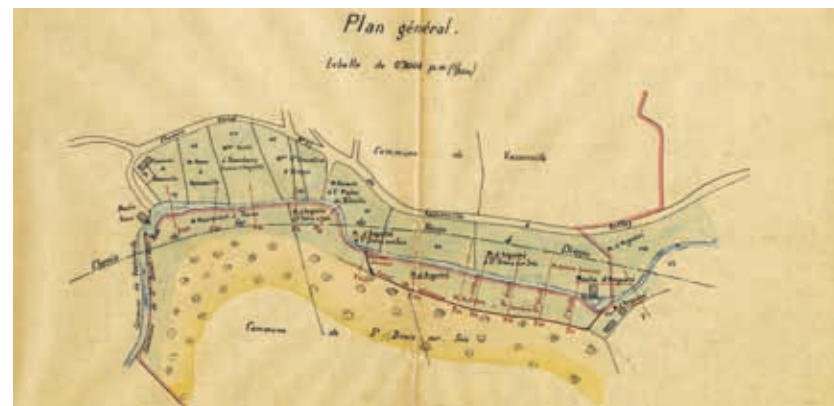
Plan de Vassonville indiquant l'emplacement de grilles en amont du moulin que M. d'Argentré a eu l'autorisation de faire installer : le canal de décharge permet à l'eau de retrouver son cours naturel, 1910, ADSM 7S717.
